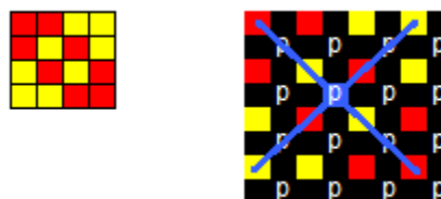
Figura 35. Píxel 'p' de muestra interpolado mediante el uso de dos diagonales de tendencia sobre ese punto.
