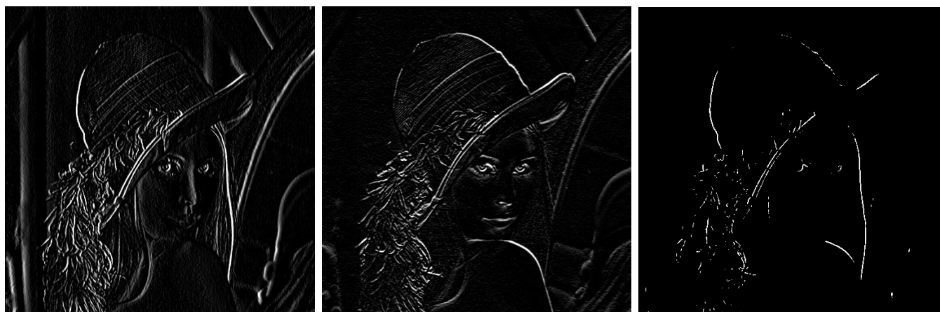
Figura 75. Imagen de Lenna convolucionada con máscara vertical y horizontal de Sobel y resultado definitivo de los bordes absolutamente blancos con valor de nivel de gris 255.
