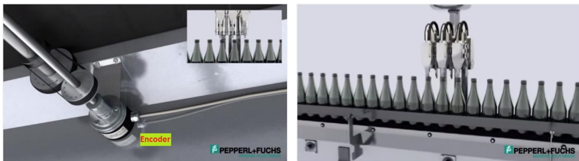
ILUSTRACIÓN 117: DEMO. DOSIFICACIÓN DE BOTELLAS SEGÚN POSICIÓN CONTROLADA POR ENCODER. © PEPPER+FUCHS
