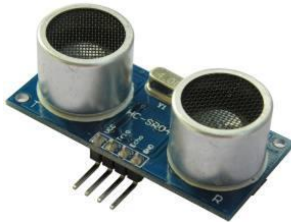
ILUSTRACIÓN 131: MODELO ULTRASÓNICO CON EMISOR Y RECEPTOR SEPARADOS
