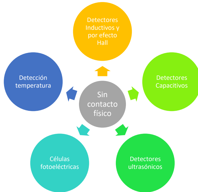
ILUSTRACIÓN 123: DETECCIÓN SIN CONTACTO FÍSICO
