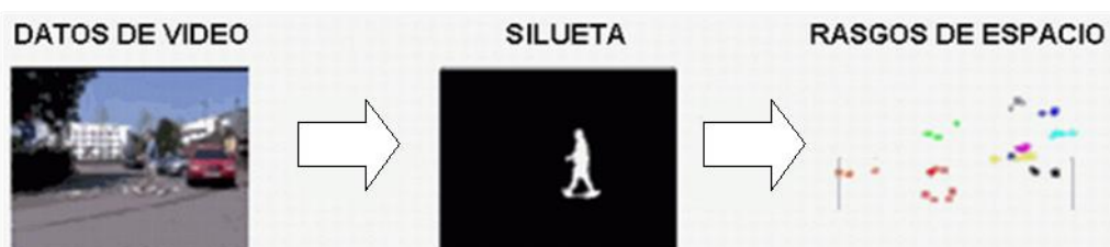
Figura 14: Extracción de Características de la Silueta
