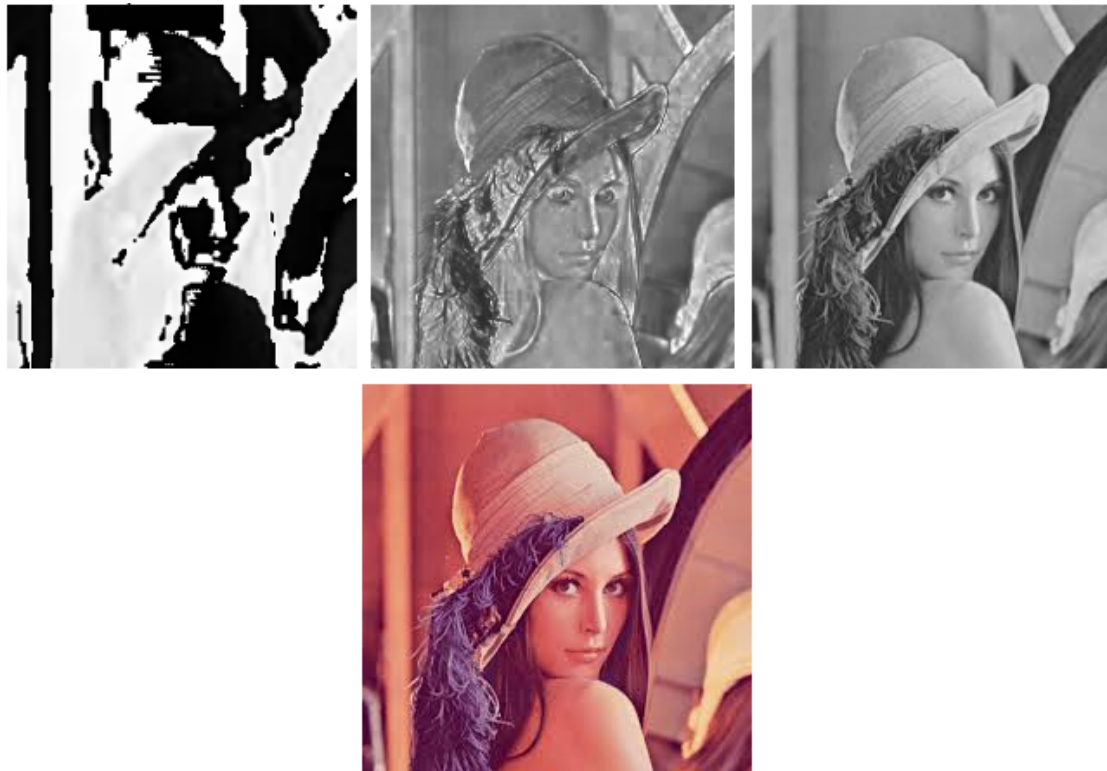
Figura 2.2 Conversión de color RGB a HSV, arriba se presentan los canales por separado H-S-V consecutivamente y abajo la imagen RGB entrante
