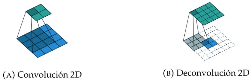
FIGURA 1.6: Convolución/deconvolución 2D con un *kernel* 3x3.
