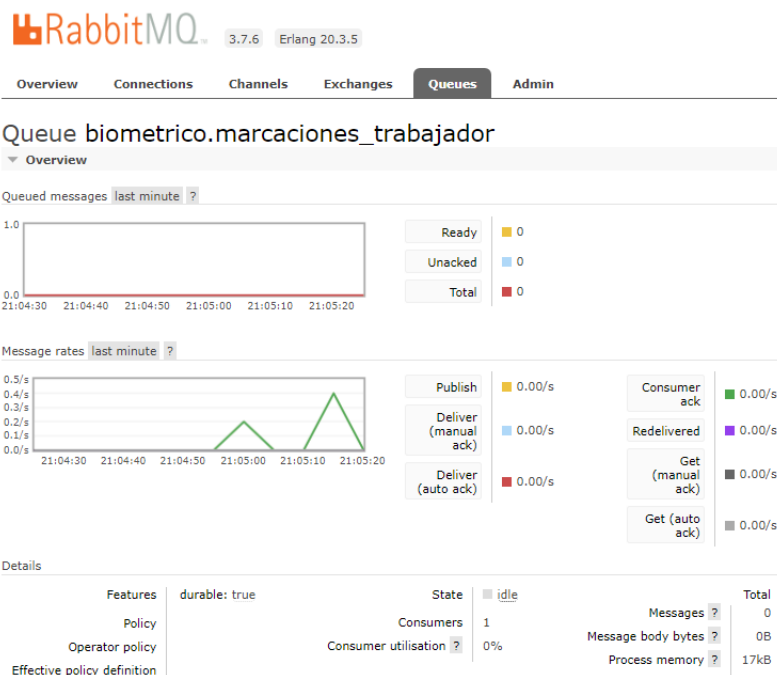
Figura 28 Pruebas de comunicación con el middleware de mensajería para los reportes de biométrico
