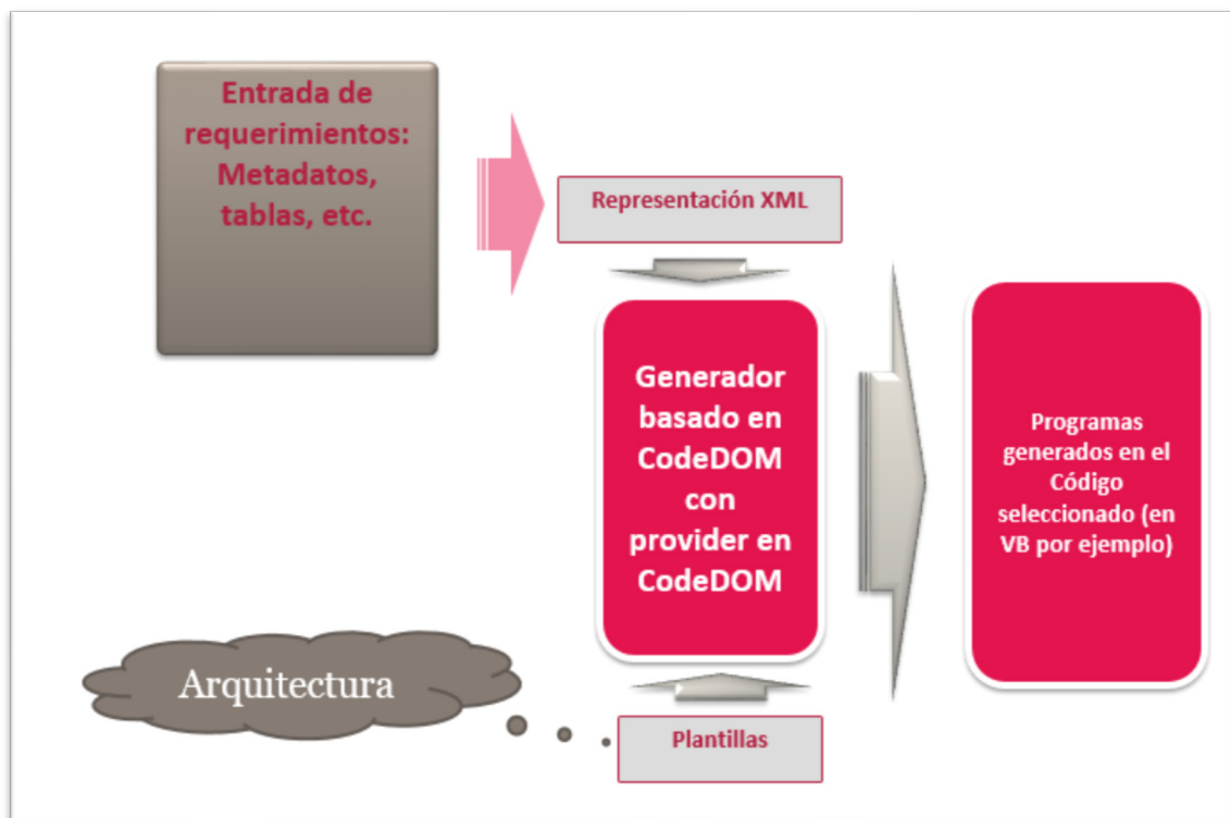
Figura 17. Funcionamiento de CodeDOM
