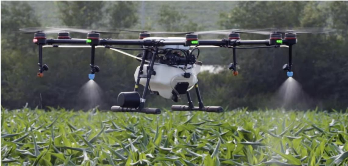
*Figura 2, Dron autónomo para fumigación de cultivos [2]*
