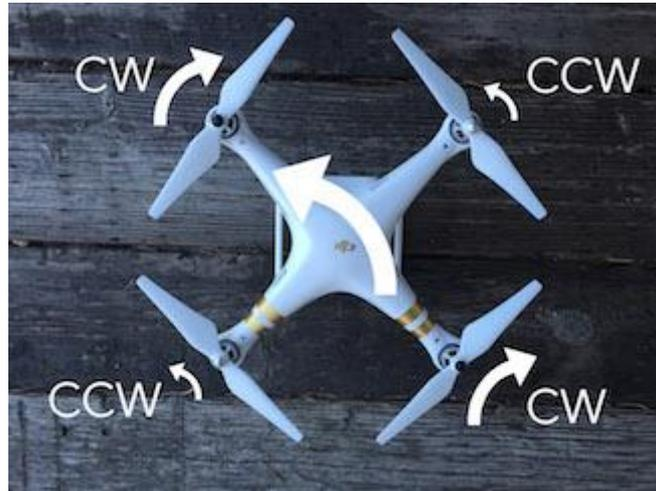
*Figura 10, Giro de dron sobre su propio eje vertical [5]*
