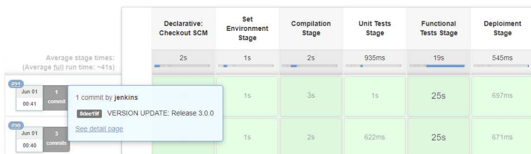
Ilustración 34: Jenkins. Pipeline de la tarea Build_release para la versión 3.0.0.
