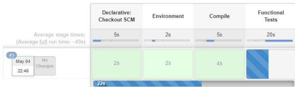
Ilustración 21: Jenkins. Pipeline de la tarea QA_FT_staging.
