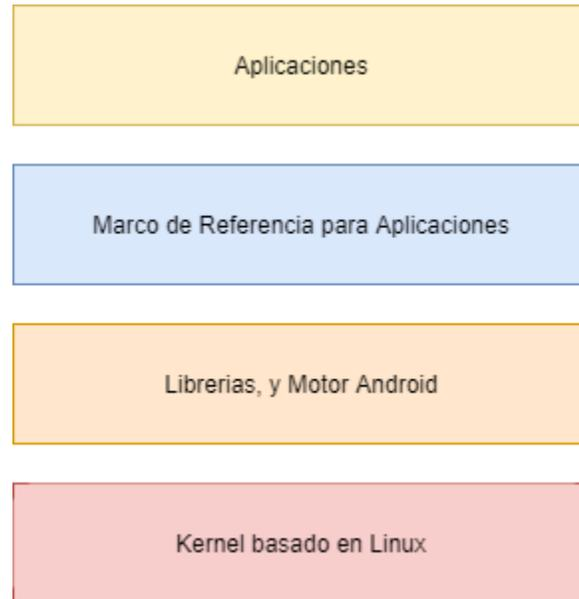
*Figura 2. Stack Plataforma Android*
