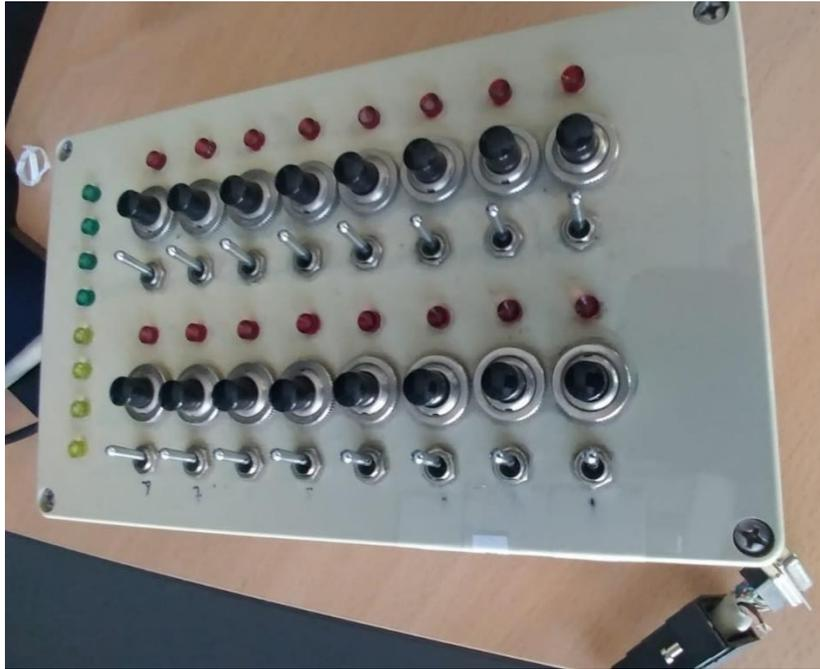
*Figura 24. Simulador de señales*
