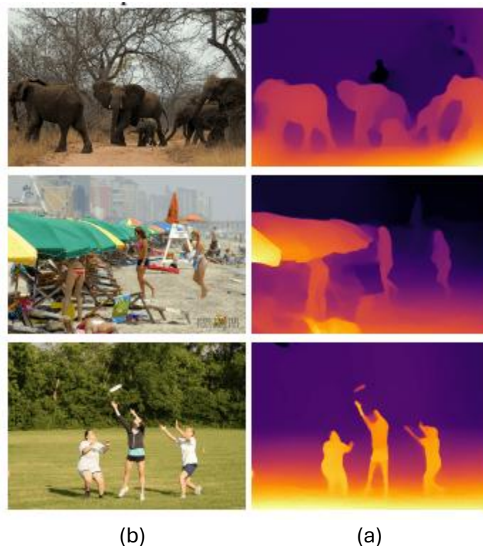
Figura 2.9 Ejemplo de resultados de Intel MiDaS, (a) la imagen de entrada, (b) el mapa de profundidad obtenido por la red neuronal. Fuente: pyimagesearch.com
