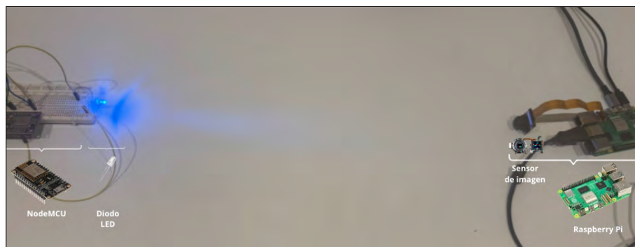
Figura 4.8: Imagen del experimento donde se aprecia el canal óptico, el sensor de imagen y la Raspberry Pi conectada a este último.
